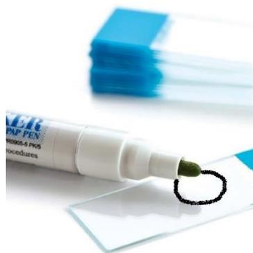
Marcador que produce una barrera hidro-repelente creando un círculo en torno a la muestra. De esta forma utilizaremos el anticuerpo necesario sin pérdidas. Eficaz para la tinción inmunológica, Inmunohistoquímica, métodos PAP, sección congelada y métodos de fluorescencia. Soporta altas temperaturas durante el proceso de hibridación in situ. Insoluble a alcohol y acetona. Se elimina con xileno si se desea.
