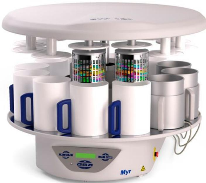
El STP-120 se sirve de una técnica patentada y única que combina diferentes movimientos para lograr una perfecta infiltración de los tejidos, ofreciendo **resultados equivalentes a los obtenidos por el método de vacío**
